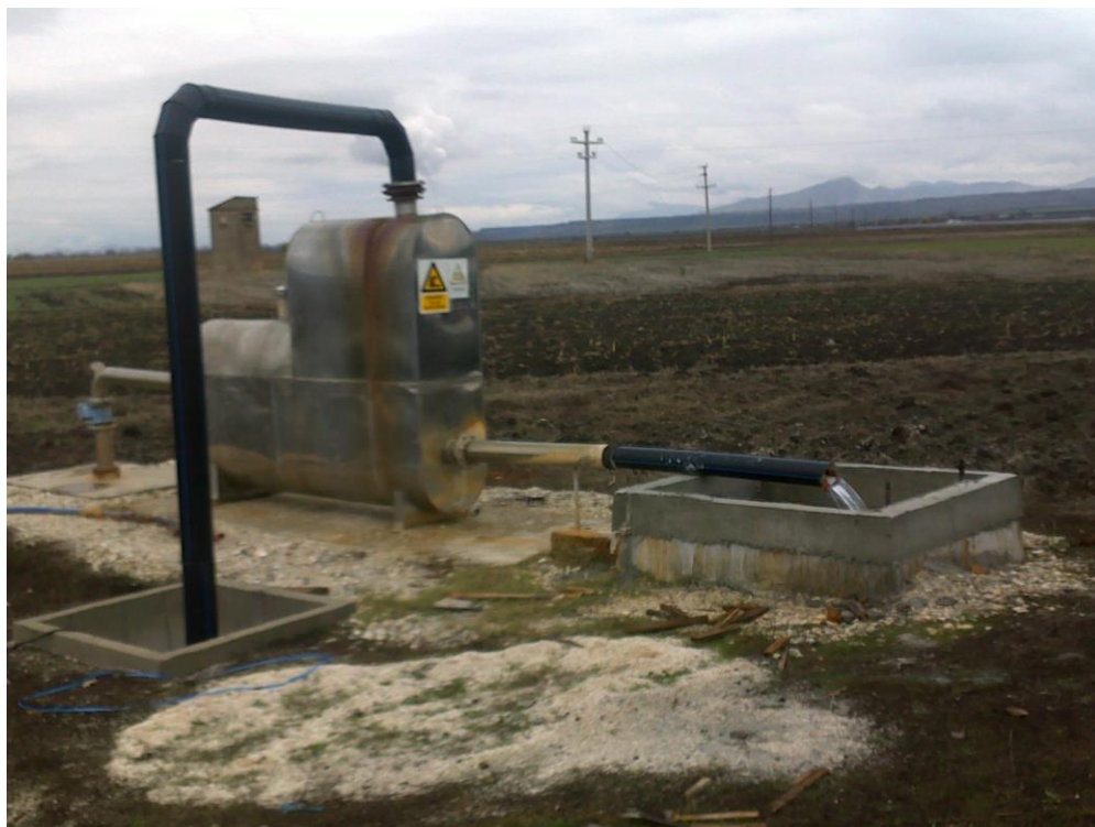
Слика бр.11 Извирање, сепарирање на суров гас од вода-DZ 4
